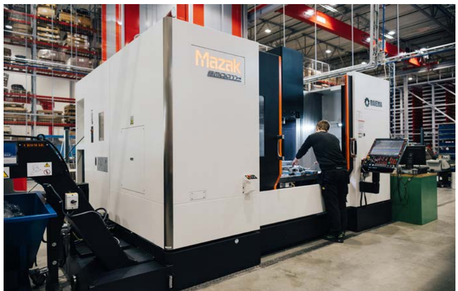
Arbeidsområdet for denne maskinen er x = 1700 mm, y = 750 mm og z = 700 mm. Det burde være nok for de fleste oppgaver.
