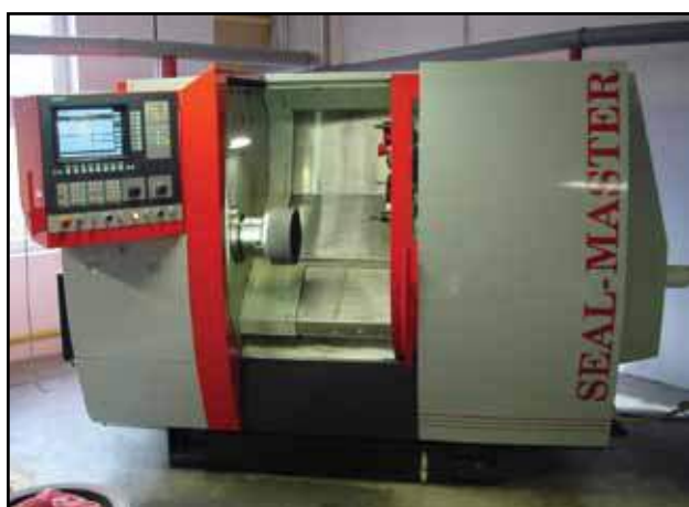
CNC-styrt maskineringscenter med spesial program for pakninger.
