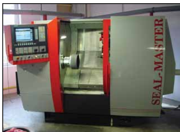
CNC-styrt maskineringscenter med spesial program for pakninger.
